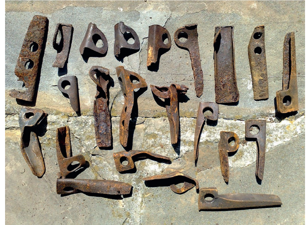
Zachowane haki wybite ze ściany Zamarłej z dróg Prawy Heinrich, Klasyczna i Motyka. Część haków rozleciała się po uderzeniu młotka i spadła pod ścianę. (fot. Artur Paszczak)
