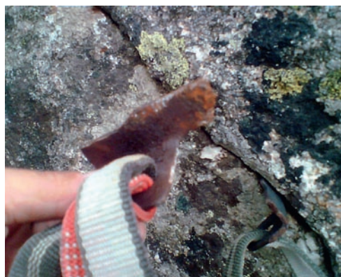
Heinrich after – haki po wybiciu: listek pękł w połowie po jednym uderzeniu (fot. Artur Paszczak)
