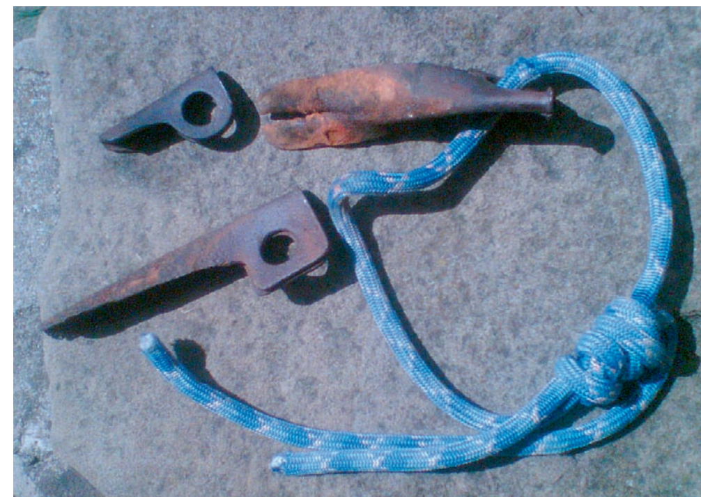
Haki stanowiskowe wydobyte z Klasycznej . Od lewej: pęknięta w poprzek po uderzeniu młotkiem V-ka ze stanowiska pod końcowym zacięciem, pęknięty wzdłużnie hak z pierwszego stanowiska (pod Sayonarą ), mocno skorodowany i pęknięty hak ze stanowiska pod Górnym Trawersem . (fot. Artur Paszczak)
