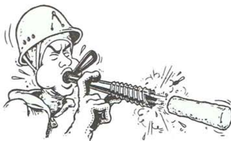
Rys. 5. Nigdy nie dotykaj na mrozie metalowego ekwipunku ustami. Opróżniając wnętrze rurowej śruby z lodu (zrób to natychmiast po wykręceniu śrubki), stuknij nią w obuszek młotka, skałę, ewentualnie przepchaj ostrzem dziabki lub igłą do trawek. Wybierając się na długie, lodowe drogi, postaraj się o rodzaj lodowego jebadełka (kawałek sztywnego drutu, o odpowiedniej długości, z zagiętym uchem na jednym końcu, w celu przypięcia karabinkiem do uprzęży) (rys. Climbing, No 147).
